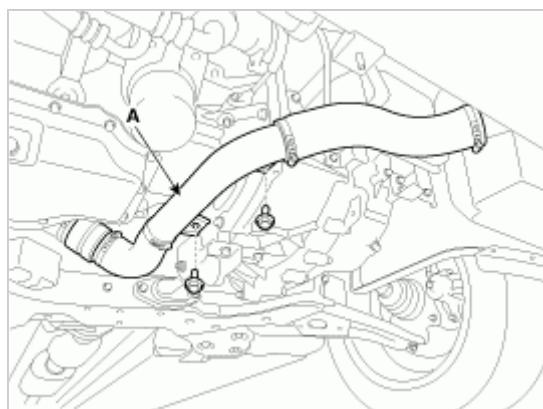
8. 分离散热器上部软管(A)和中冷器排出软管(B)。
